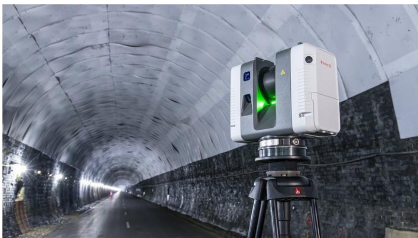
Attēls 7: Lāzera impulsa (pulse-based) 3D skenēšana [9].
