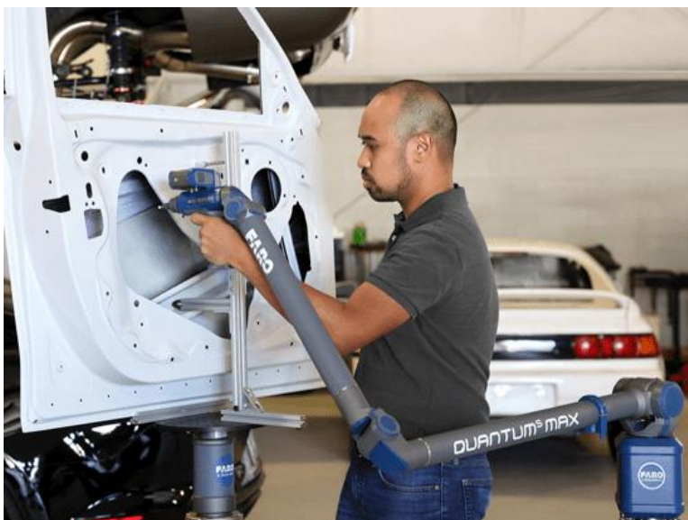
Attēls 6: Kontakta 3D skenēšana [7].
