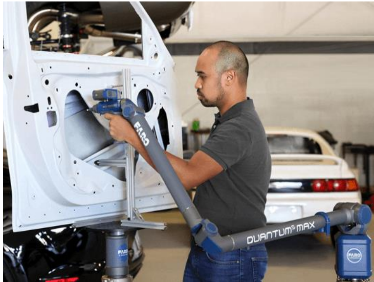
Ilustración 6: Escaneo 3D de contactos [7].
