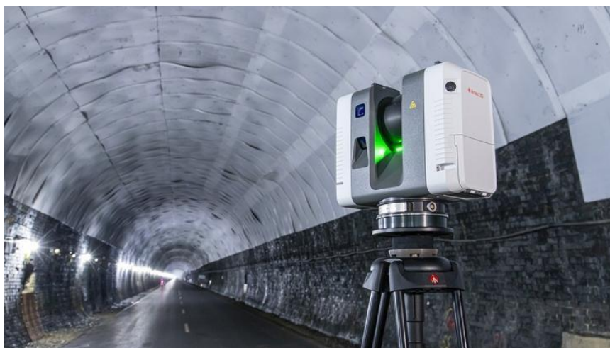
Ilustración 7: Escaneo 3D basado en pulsos láser [9].
